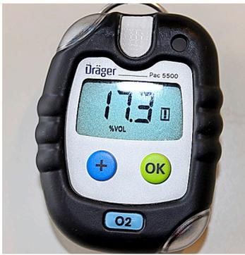
Sauerstoff-Warngerät für die Sicherheit. Hier werden 17,3 % O<sub>2</sub> in der Atemluft angezeigt.
