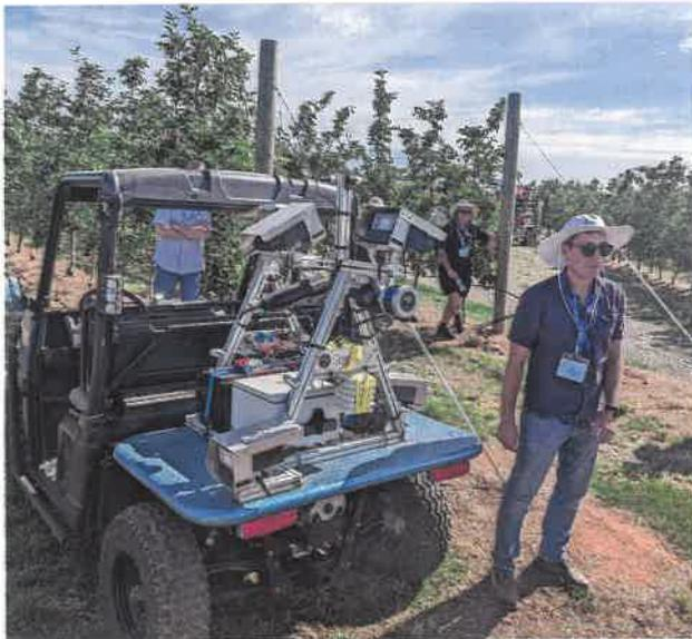
**Die gesamte Erfassung von Baumvolumen, Blattfläche und Licht, Blühintensität sowie Fruchtbehang ist mit dem System von Green Atlas möglich**
