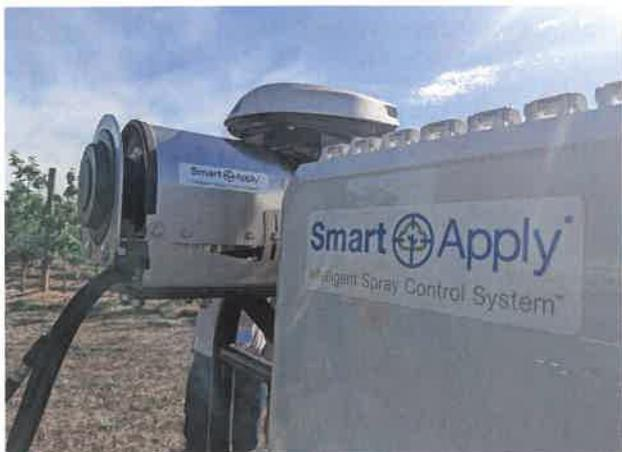
Das autonome Fahrssystem von Smart Apply – Intelligent Spray Control System® kann mit jedem serienmäßigen Sprüher kombiniert werden. Ein 270° Lidar-Scanner erfasst das Baumvolumen während der Überfahrt von beiden Baumseiten
