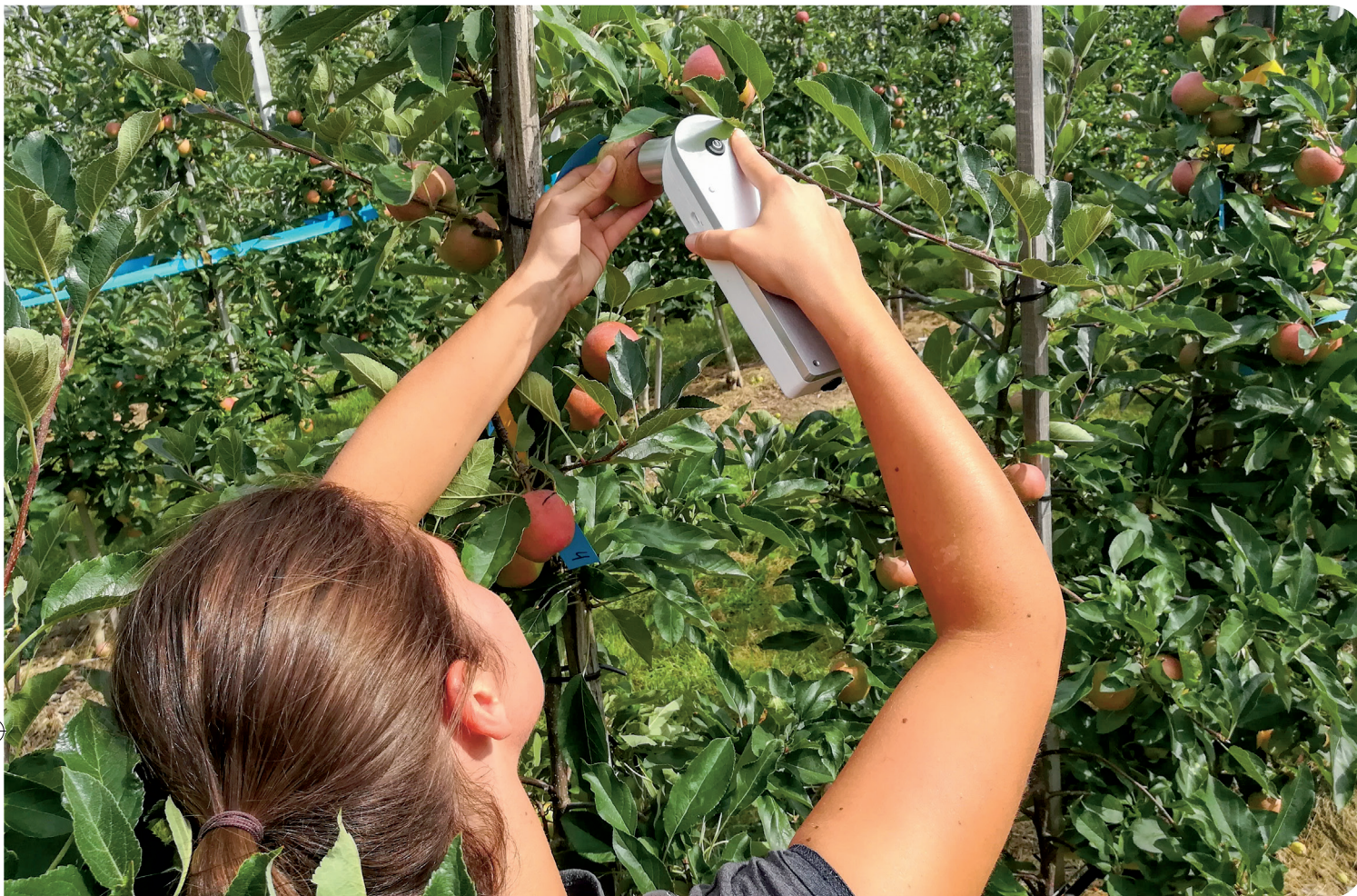
ERFASSUNG VON FRUCHTEIGENSCHAFTEN zur Erntezeit mittels eines neu entwickelten Spektrometers.
