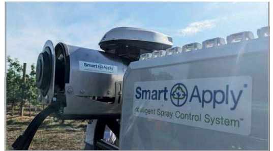
Ein 270°LiDAR Scanner erfasst das Baumvolumen während der Überfahrt
