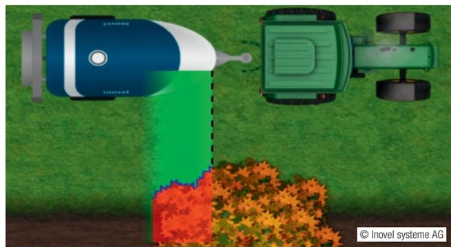
Abb. 3: Schematische Darstellung der LiDAR-Sensorik (light detection and ranging) des Spritzcomputers zur Erfassung des Baumvolumens und gezielter Pflanzenschutzmittel Reduktion im Obstbau
