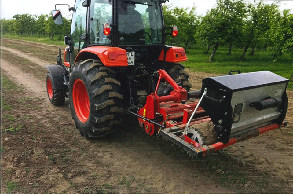
Foto 4: Die Umkehrfräse im Einsatz.
